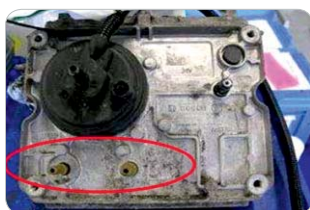
Chýbajúce záslepky na vývodoch
