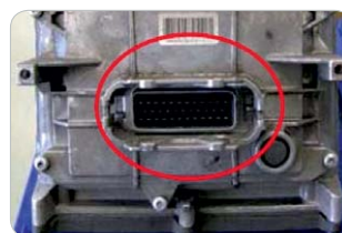
Chýbajúce záslepky na elektrickej zásuvke
