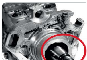
Poškodený hnací hriadel' a príruby, zafarbenie spôsobené prehriatím
